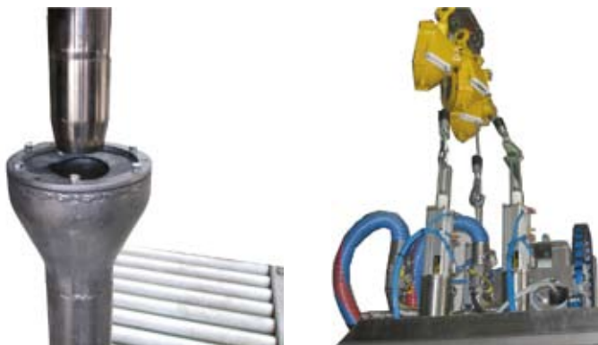
Cono de limpieza para la reducción de la generación de residuos en los procesos de limpieza de las líneas y diversas cañas en máquina siempre conectadas a llegadas de producto para evitar derrames y paradas.
