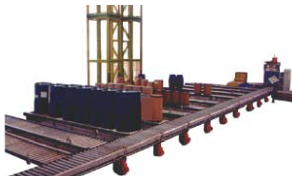
Sistema de acumulación para la agrupación de residuos en diferentes familias y previo al envío a triturado y combustión.
