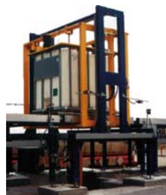
Volteado y limpieza de contenedores.
