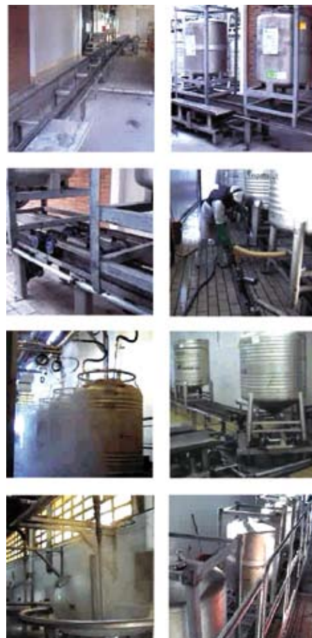
Sistema de gestión de envases metálicos para la limpieza interior y exterior.
