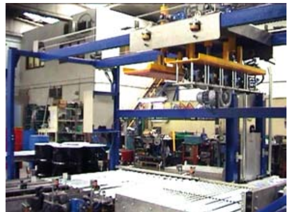
PBC-200: Paletizadores automáticos de bidones, toneletes, garrafas y cubetas a varios pisos.
