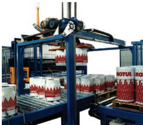
PBC-200: Paletizadores automáticos de bidones, toneletes, garrafas y cubetas a varios pisos.
