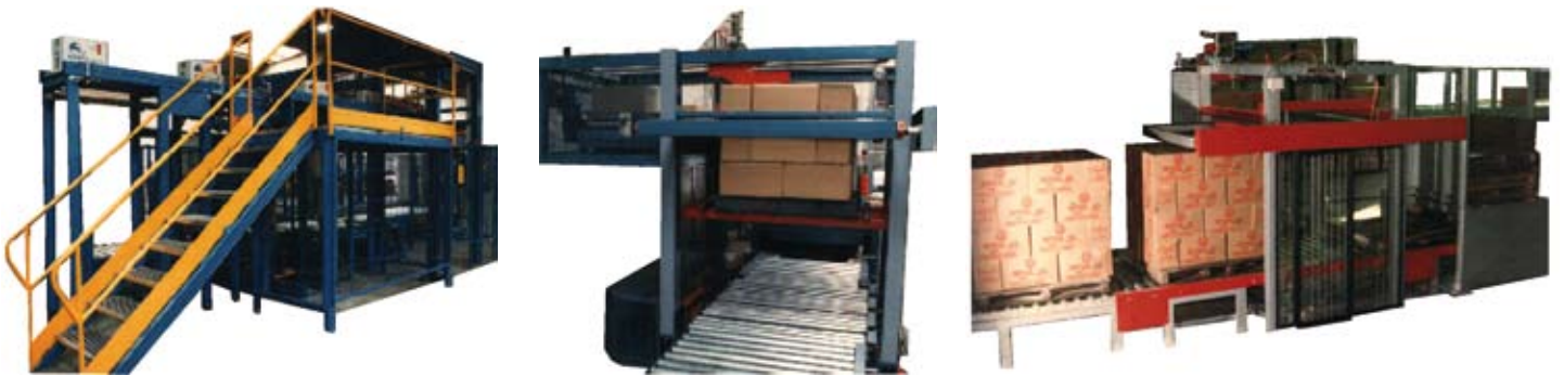
HB-1000: Paletizadores de Carga Alta para cajas, sacos o fardos.
