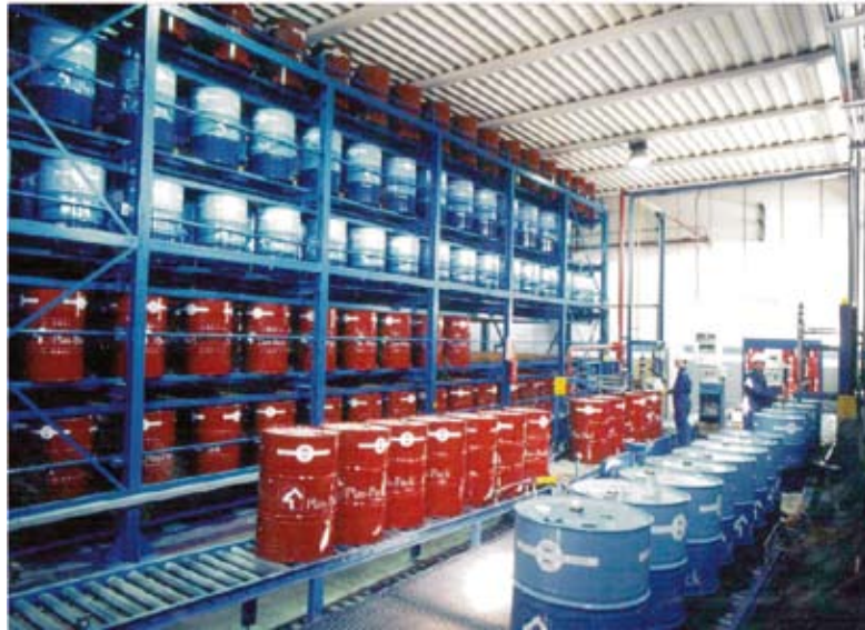
SAT-5 Almacén automático para bidones vacíos con capacidad para 1.200 bidones
