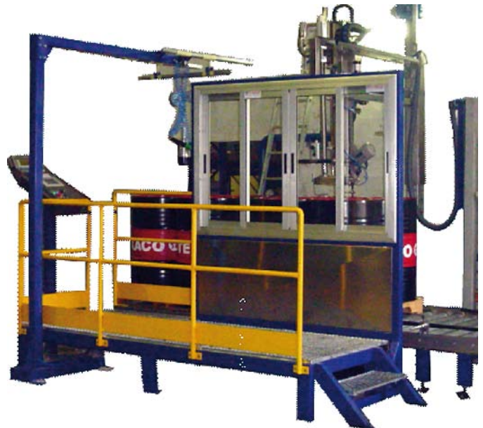
PST-1000: Llenado sobre p alet semi autom tico. Introducci n y extracci n del p alet en autom tico. Posicionamiento de ejes manual.
