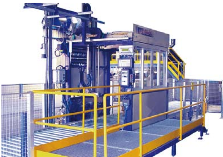
PST-1001: Llenado sobre p alet autom tico. Introducci n y extracci n del p alet en autom tico. Posicionamiento de ejes por CPM -Control Previa Memorizaci n- con opci n de VA -Visi n Artificial- para la b squeda de los orificios.
