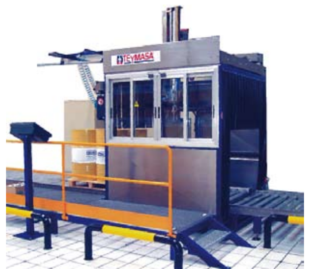
PST-1001: Llenado sobre p alet autom tico. Introducci n y extracci n del p alet en autom tico. Posicionamiento de ejes por CPM -Control Previa Memorizaci n- con opci n de VA -Visi n Artificial- para la b squeda de los orificios.
