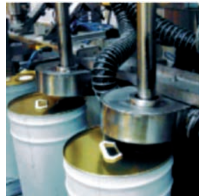
Figura 12 Campanas de aspiración de gases en la zona de envasado
